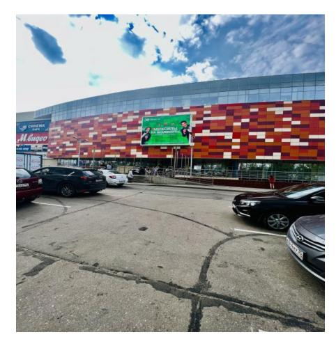
Размер изображения 8,32х 6,08 метра, разрешение 312х228 физических пикселей. В модель интегрирована система виртуального пикселя - это удваивает качество изображения, виртуальное разрешение 624х456. Шаг пикселей 26 мм.
